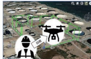
自動航行PoC（目視内）：タンクエリア自動巡回点検
