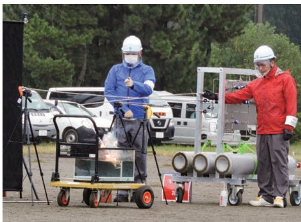
モノシランガスを水槽に放出すると、ガスが空気中に出た瞬間に着火
