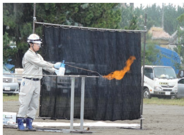
水素の火炎に食塩水を噴霧し、ナトリウムの炎色反応で燃焼していることを確認
