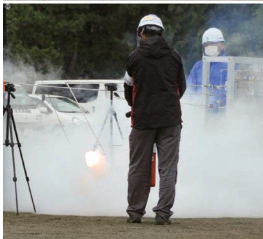
モノシランガスを空気中に出すと直ちに着火し、消火器でも消えない。
