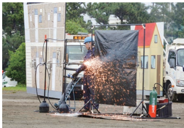
酸素を通すと、鉄パイプも着火し、燃焼する。
