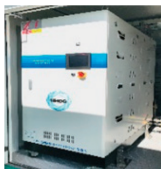
図7 水電解水素発生装置
