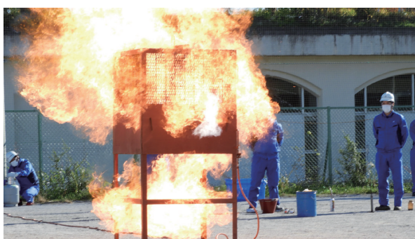
LPG 消臭剤(250mL)入リスプレー缶 38秒で燃焼爆発
