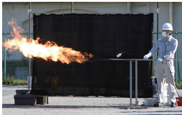
水素の火炎に食塩水を噴霧してNaの炎色反応で燃焼していることを確認 ((株)渡商会)
