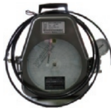
図8 検査機器(気密試験用 自記式圧力計)
