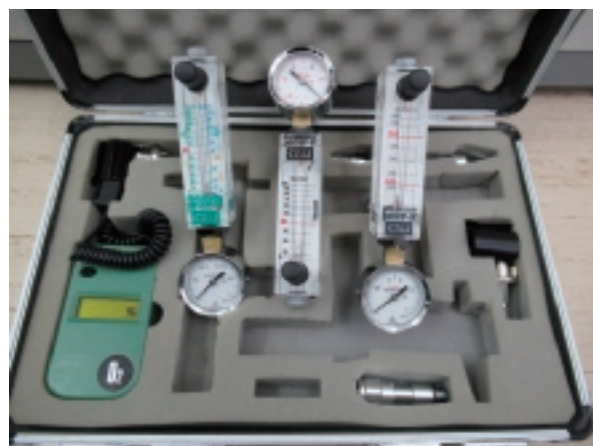
図9 検査機器 (配管端末器検査用 アウトレットテスター 酸素濃度計)
